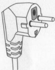
Ce four à micro-ondes est équipé d'une prise électrique de terre. Il doit être branché sur une prise murale correctement installée et équipée d'une prise de terre.
